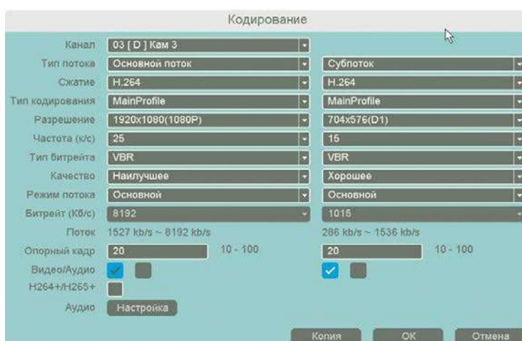
Кнопка **Кодек** открывает таблицу с параметрами кодирования подключенной IP камеры.
