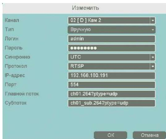
**Главный поток** – часть строки запроса RTSP 1 видеопотока, **следующей за IP адресом и портом устройства** (в примере **ch01.264?ptype=udp**)
