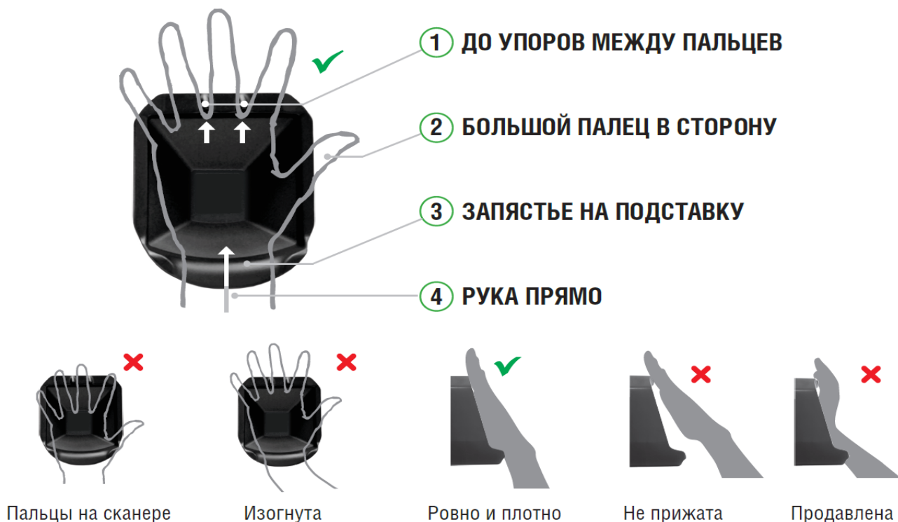
Рисунок 4 – Правила прикладывания ладони к сканеру терминала
