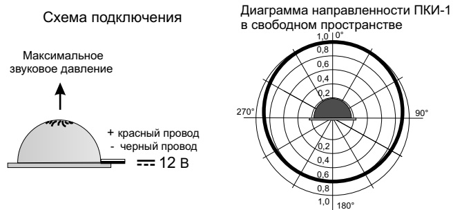
Рис.2 Схема подключения и диаграмма направленности оповещателя ПКИ-1.
