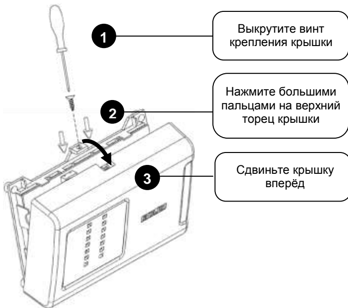
Рисунок 2. Снятие крышки АСР8
