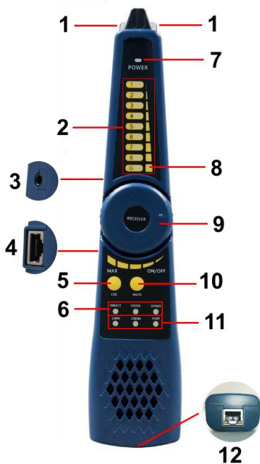
Рис. 100 Мультифункциональный щуп, разъемы и индикаторы
