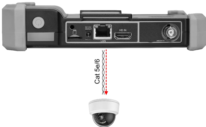
Рис. 6 Подключение IP-видеокамеры к тестеру
