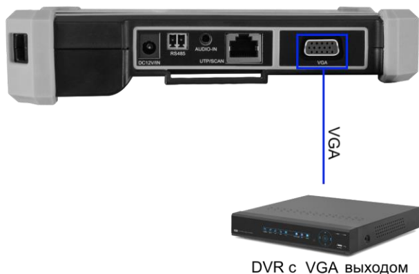
Рис. 11 Подключение VGA устройств к тестеру.
