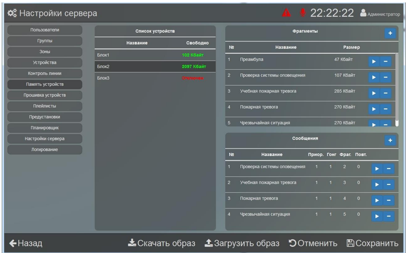
Рисунок 25. Настройки памяти блока.
