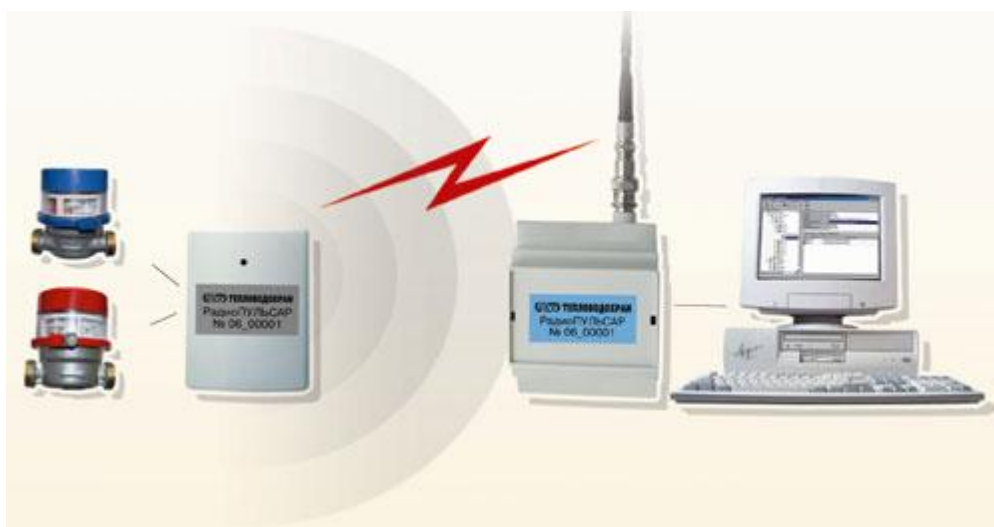
Рисунок 1 - Принцип работы Пульсар 16PM
