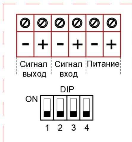
Рис. 3а – Схема подключения оповещателя с клеммными зажимами.
