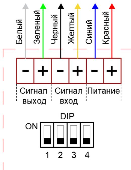
Рис. 3б – Схема подключения оповещателя с питающим кабелем.
