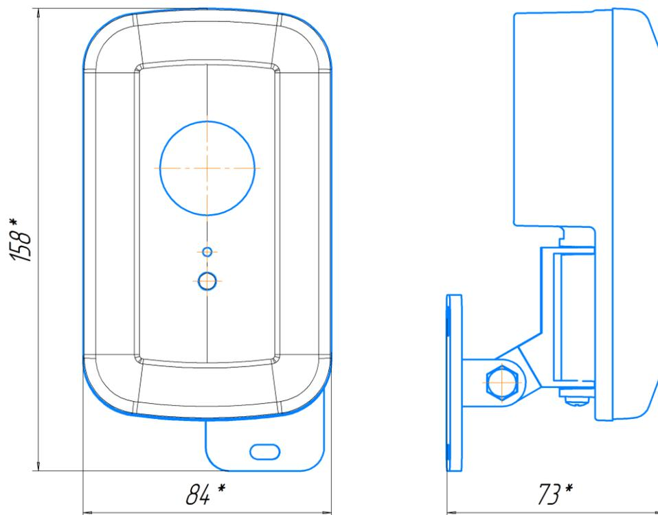
Рисунок 2 – Оповещатель пожарный взрывозащищенный звуковой, комбинированный
