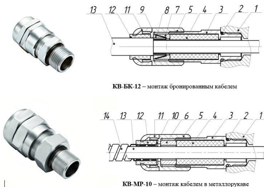
Рисунок 5 – Вводные устройства с двойным уплотнением
