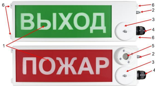
Рис. 1 – Внешний вид оповещателя. 1-табло; 2-место заземления; 3-крышка коммутационного отсека; 4-кабельный ввод; 5-звуковой излучатель; 6-крепежные отверстия (4 шт).
