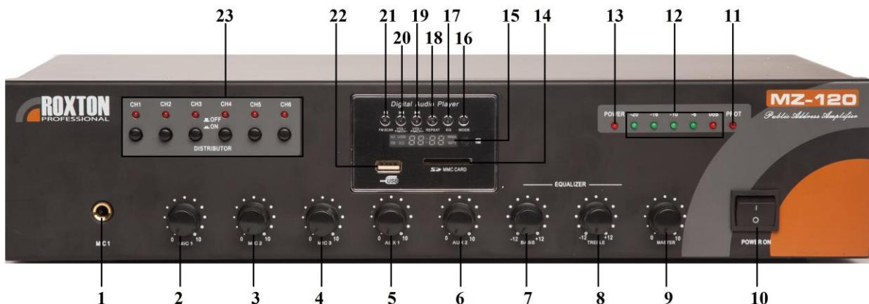
1. **Микрофонный вход MIC 1** - разъем (TS 6.35) для подключения приоритетного микрофона. Сигнал, поданный на вход MIC1, подавляется все остальные (если активирован регулятор 8 «MUTE» на задней панели) или смешиается с ними
