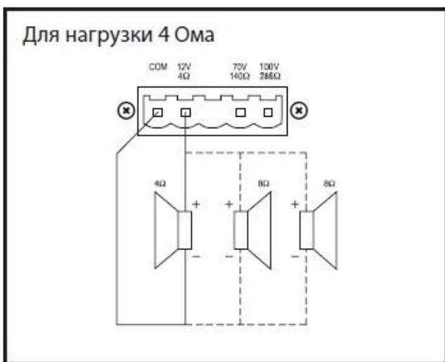
Схема подключения трансляционных линий 70 и 100 В.
