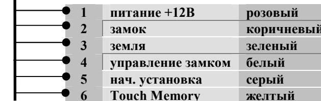
Дополнительное контактное устройство Touch Memory
