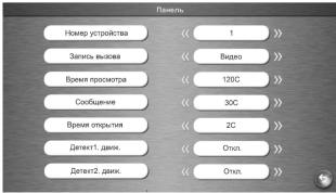
Номер устройства: вызывные панели подключаются только к устройству №1.
