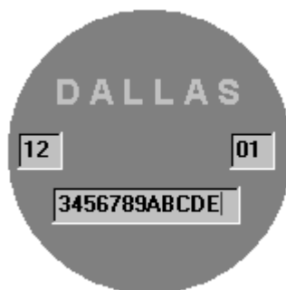
Рисунок 8. Пример расположения кода на ключе Touch Memory
