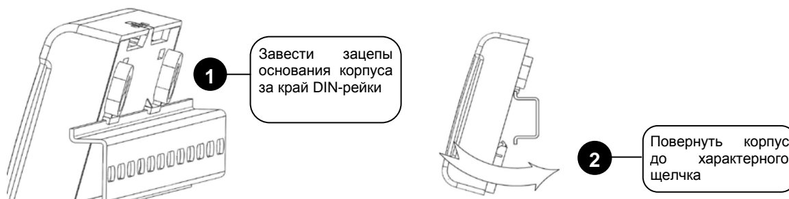
Рисунок 17. Монтаж устройства на DIN-рейку
