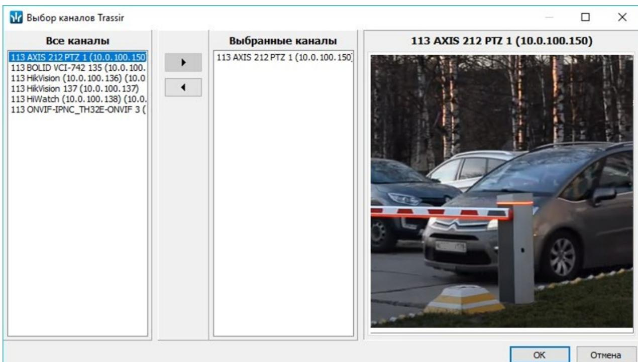
3. В поле **Все каналы** отображены доступные для привязки видеоканалы, а в правой части окна имеется возможность просмотра изображения с выбранной камеры. С помощью кнопок / добавьте нужные видеоканалы в поле **Выбранные каналы** и нажмите кнопку **OK**. Окно **Выбор каналов Trassir** будет закрыто, выбранные видеоканалы будут привязаны к ресурсу и добавятся в список вкладки **Каналы Trassir**.
