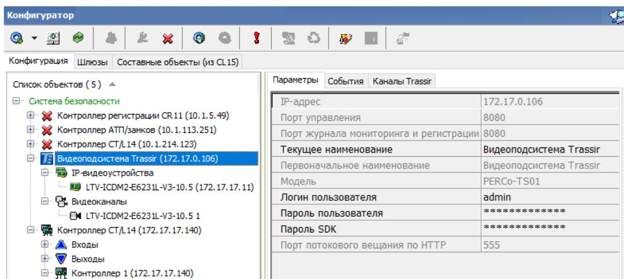
7. Проверьте наличие необходимых видеоканалов в подменю видеоподсистемы, при необходимости нажмите кнопку **Обновить конфигурацию** (Ctrl+Alt+K), расположенную на панели инструментов раздела.
