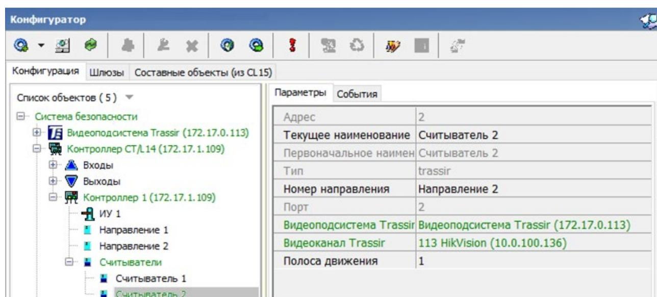
5. Выбрав нужные значения в полях **Видеоподсистема Trassir** и **Видеоканал Trassir**, нажмите кнопку **Передать параметры (Ctrl+H)**, после чего в Web-интерфейсе контроллера все параметры будут заполнены автоматически:
