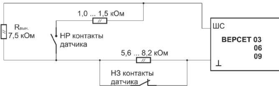
Рис.6. Схема включения технологических датчиков в ШСТ.
