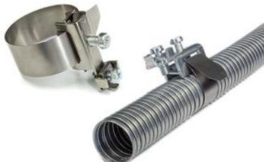
При отсутствии возможности установки заземляющего устройства на вводную муфту ВМ или ВМУ, заземление металлического рукава выполняется с помощью хомута заземления Промрукав. Это устройство заземления возможно установить в любом наиболее удобном месте. Хомут устанавливается на металлический рукав и с помощью винтового зажима, зажимается на нем.
