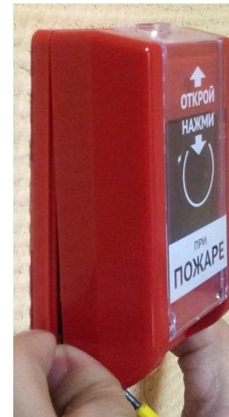
Для включения питания извещателя удалите (вытяните) бумажную ленту, изолирующую контакт основной батареи извещателя. Резервная батарея установлена и готова к работе.
