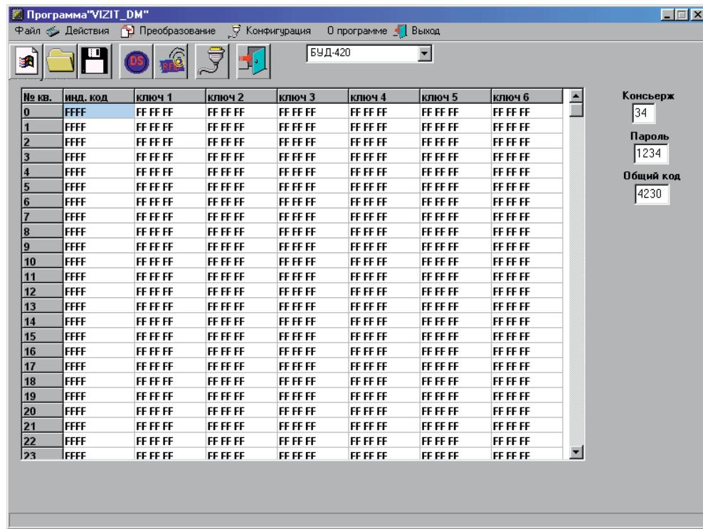
Для набора кодов доступа наведите указатель мыши компьютера на требуемую ячейку таблицы и нажмите левую кнопку. В дальнейшем, после набора четырех цифр код автоматически вводится в ячейку, а маркер смещается на следующий код доступа. Сервисный, системный пароль и общий код доступа изначально установлен согласно эксплуатационной документации на соответствующее изделие. Смена сервисного, системного пароля и общего кода доступа производится аналогично.
