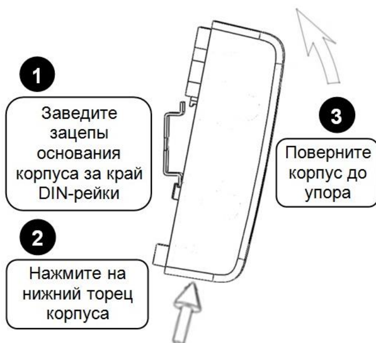
Рисунок 8.3 Крепление на DIN-рейку
