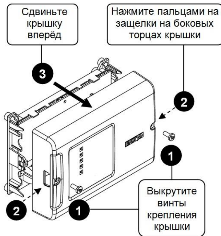
Рисунок 8.2 Снятие крышки
