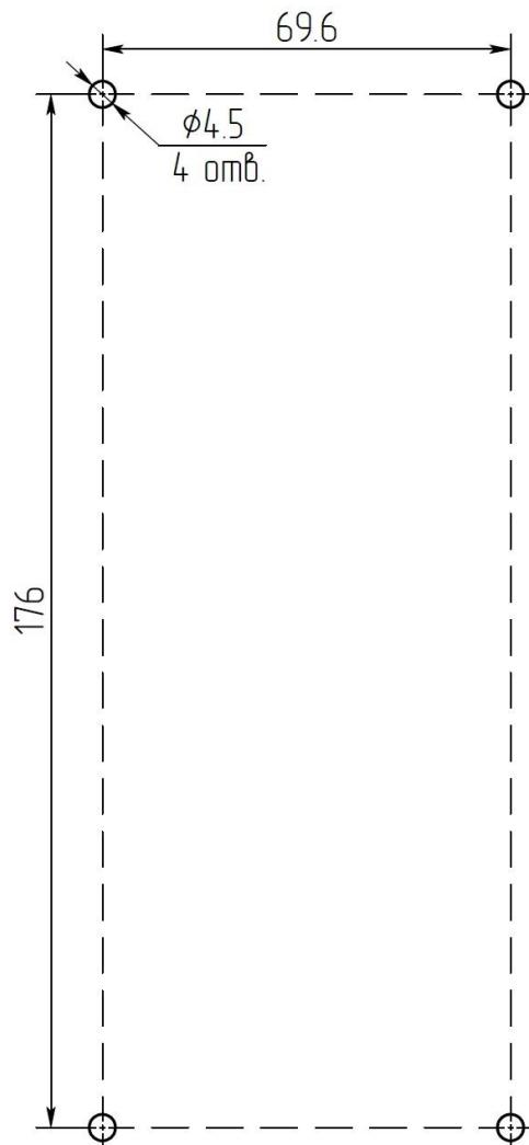
**Габаритные и установочные размеры выносного элемента ЭВ**
