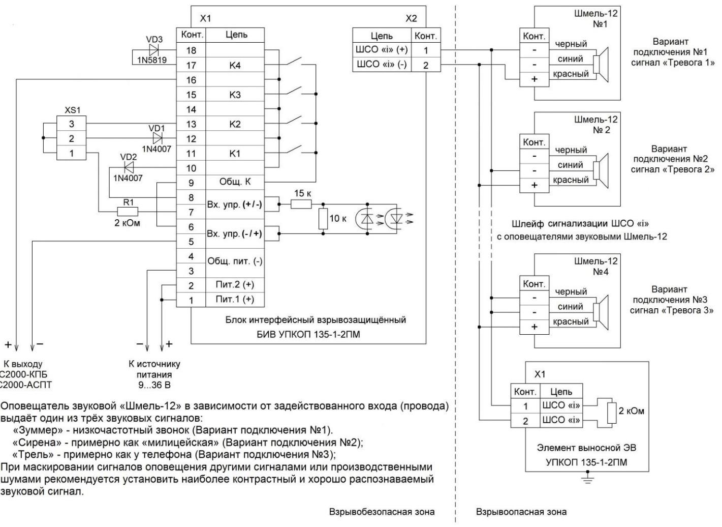
Оповещатель звуковой «Шмель-12» в зависимости от задействованного входа (проводов) выдаёт один из трёх звуковых сигналов:
