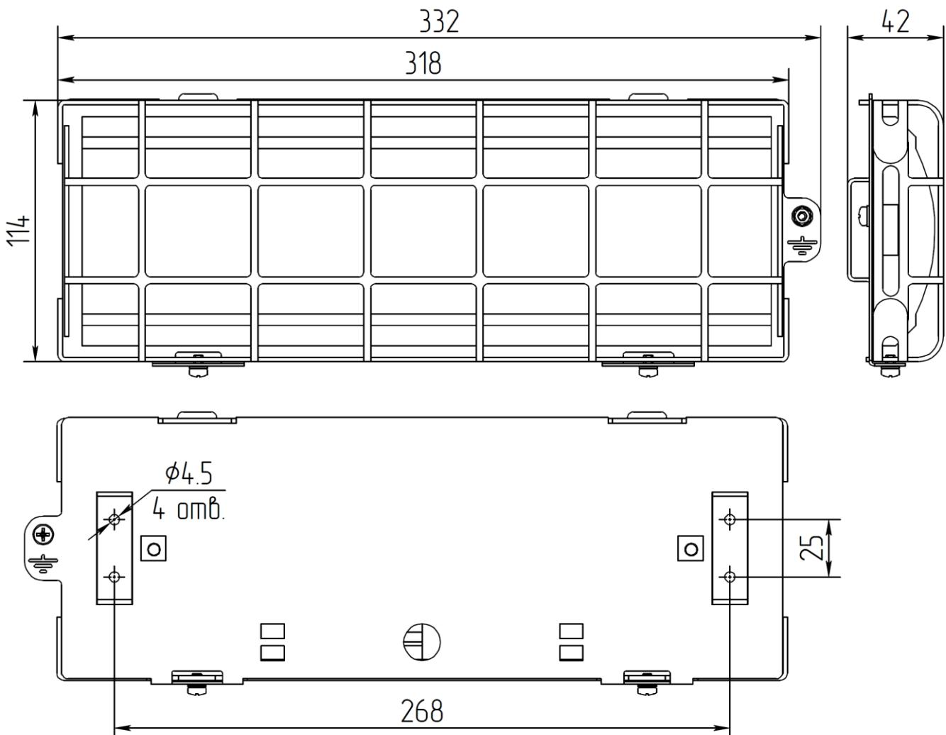
**Габаритные и установочные размеры оповещателя светового ОС**
